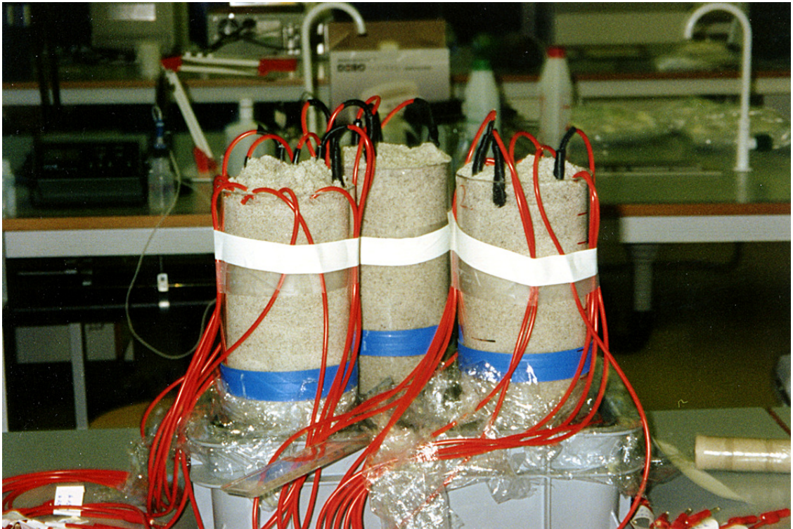
Figur 4. Fuktning av jorden i provcylindrar.
